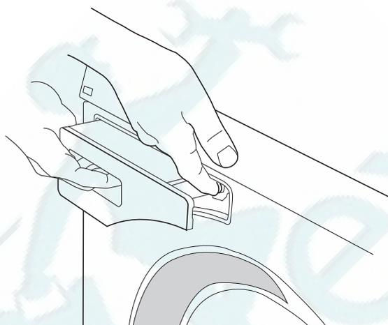
После того как предохранительная защелка, не допускающая открытие отсека детьми, будет активирована, необходимо нажать открывающую кнопку, чтобы выдвинуть отделение для моющего средства.
